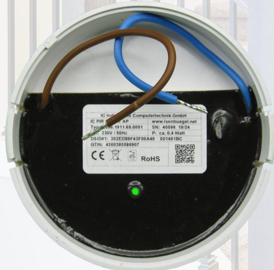
LED innenliegend, zur mehrfarbigen Anzeige der dS System Funktion.
